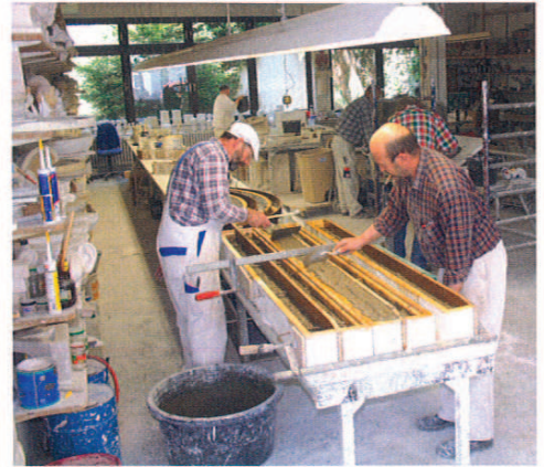
3 In der Stuckwerkstatt der Firma Belz wurden für den Kaiserplatz mehrere hundert Meter Stuckprofile erstellt.
